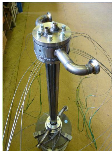
3. ábra: VVER köteg a CODEX berendezésben
