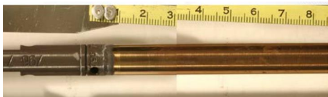
5. ábra: A KAERI PWR körülmények között a Halden reaktorban tesztelt CrAl bevonatos burkolatmintája [8]
