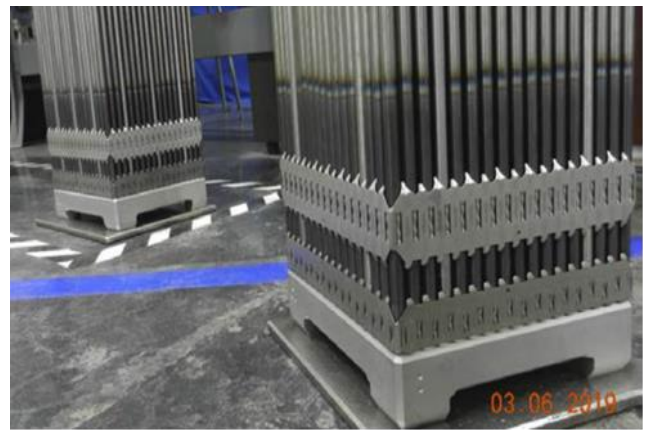
2. ábra: A Westinghouse EnCore üzemanyaggal töltött kazettái a Byron Atomerőmű 2. blokkján [3]
