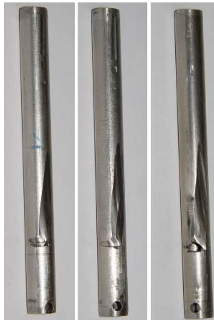
6. ábra: A szabad mozgású huzallal koptatott mintákról készült felvételek (a jobboldali minta lyukadt át)
