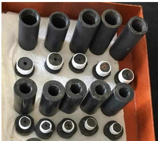
1. ábra: Rozsdamentes acélból készült mintatartó tokok
