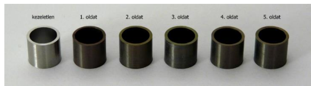
8. ábra: Kezeletlen E110G gyűrű és a 7 napig különböző összetételű oldatokban kezelt (300°C, 86 bar) E110G gyűrűminták fényképe
