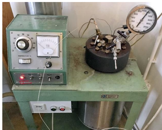
2. ábra: Nagynyomású autokláv nyitott és összeszerelt állapotban
