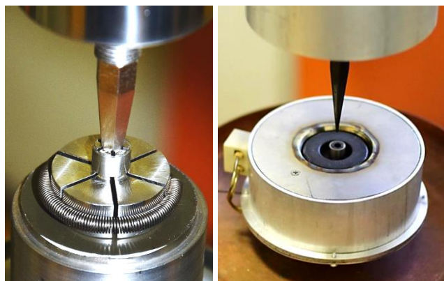
1. ábra: A próbaméréshez használt első mandrelek a szakítógépes mérés közben (balra), valamint a magas hőmérsékletű méréshez használt mandrelek a befogó szerszámmal és csőkemencével együtt, a mérés kezdeti állapotában (jobbra).
