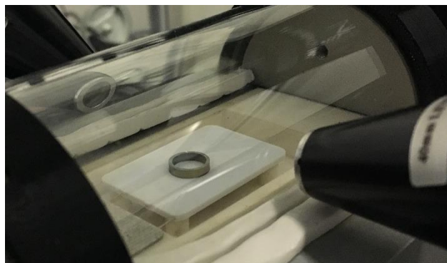
7. ábra: 9,1 mm átmérőjű, cirkónium-ötvözetből készült cső mérése M-2000DI ellipszométerrel fűthető cellában. A gyűrű metszeti felületén fókuszálással akár fűtés közben is lehet méréseket végezni. A gyűrű alatt látható fehér kerámialapka kontrollálható módon 600 °C-ig felfűthető.
