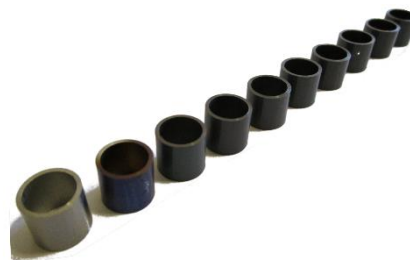
3. ábra: 9,1 mm átmérőjű, E110 és E110G kódnevű cirkóniumötvözetből készült csövek különböző hőmérsékleten és különböző ideig oxidálva.
