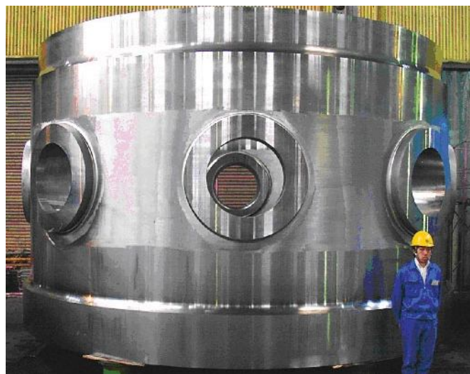
3. ábra: Egyetlen acéltuskóból kovácsolt reaktortartály csonk öv (forrás: Japan Steel Works, http://goo.gl/820HUA )
