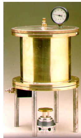
6. ábra: A Róna Erzsébet által tervezett alfa sugárzást mérő készülék
