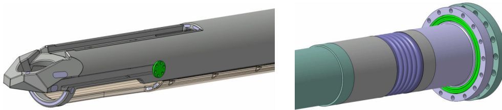
3. ábra: A kivehető cső fejének és hátsó részének részletes tervei
