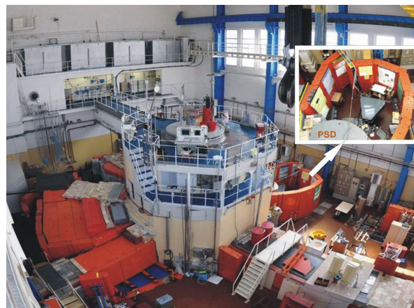
2. ábra: A Budapesti Kutatóreaktor a termikus csatornája melletti mérőberendezésekkel. A 'PSD' neutrondiffraktométer fotóját mutatja a beillesztett kép.
