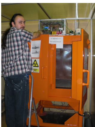
4. ábra: Referenciamérés müontomográfal a DÖME berendezés tetején.
