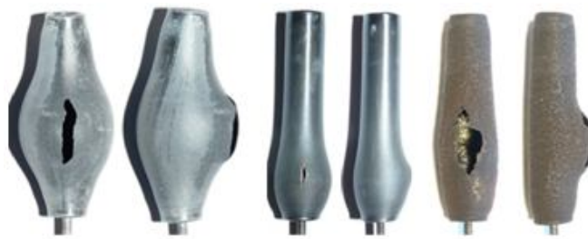
7. ábra: A 700 °C-on (bal oldali), 900 °C-on (középső) és 1200 °C-on (jobb oldali) felfúvódott mintákról készített felvételek
