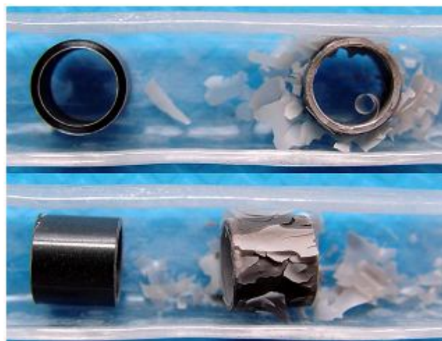
4. ábra: A 900°C hőmérsékleten, 5000 s ideig oxidált E110G (bal oldal) és E110 (jobb oldal) minták fényképe
