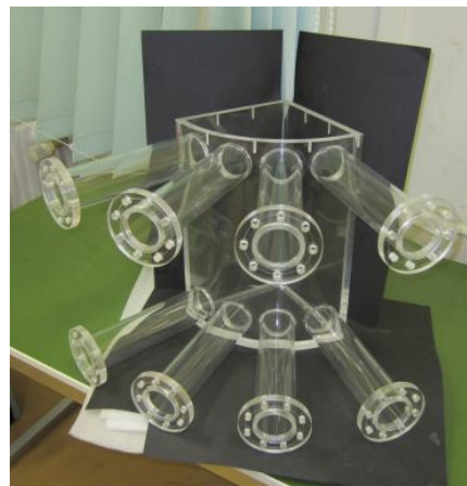
2. ábra: A modelltartály méretei, a plexitartály karimákkal
