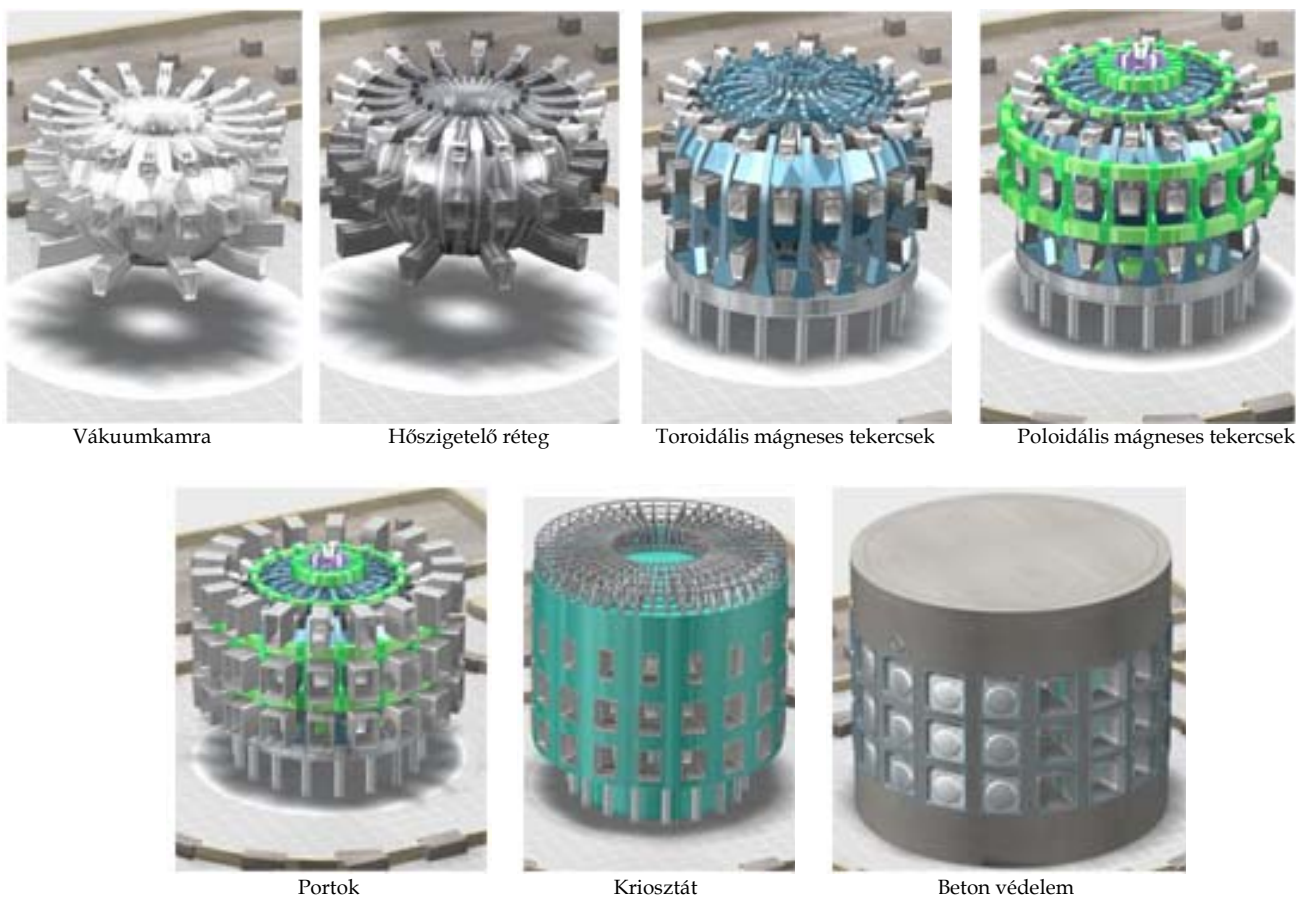
2. ábra: Az ITER tokamak felépítése „rétegenként”
