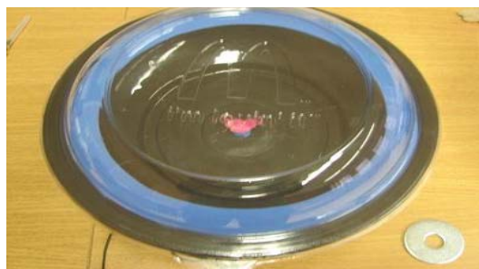
17. ábra: A kész salátatál ködkamra denaturált szeszrel átitatott szivacsgyűrűvel, közepén tóriumos gázharisnya darabbal
